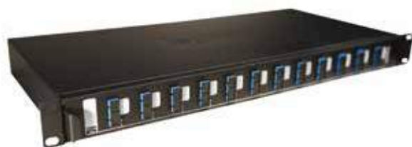
Cassetto ottico equipaggiato scorrevole: arresto a fine corsa con inclinazione a 30°. Capacità massima: 24 SC, 48 LC.
